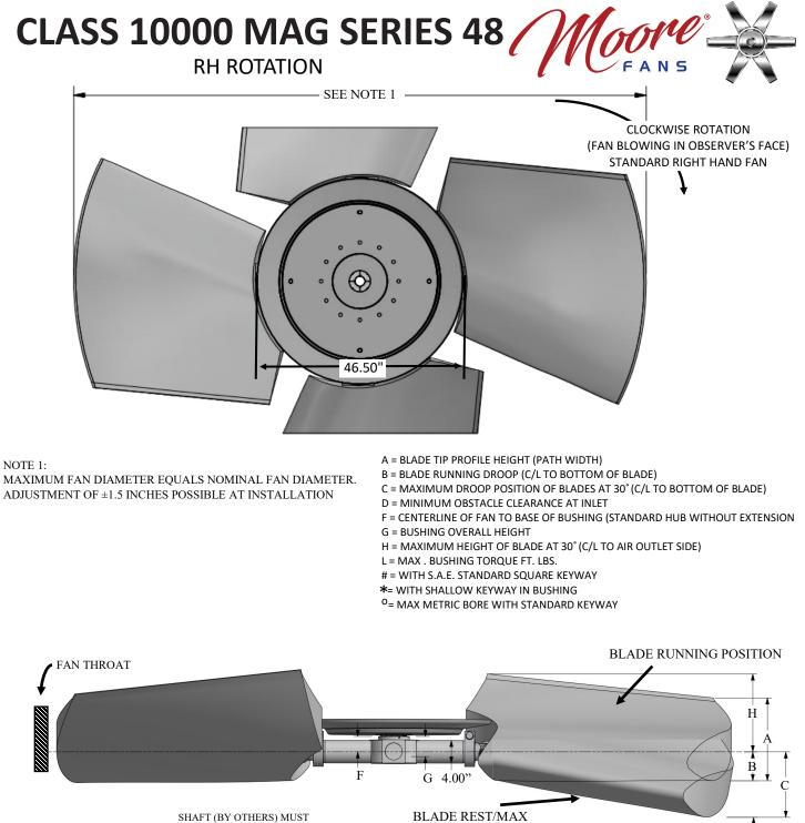
SHAFT (BY OTHERS) MUST FULLY ENGAGE BUSHING BLADE REST/MAX DROOP POSITION
